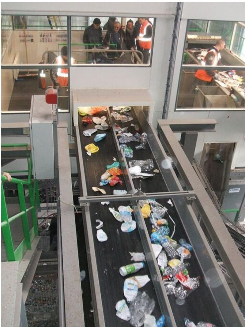
L'affinage du tri est réalisé manuellement par des opérateurs.
